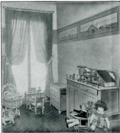
FIG. 6. — Chambre d'enfants. Le poêle à accumulation CID visible dans l'angle de la pièce, contre la fenêtre, est décoré et revêt l'aspect d'une commode. La température extérieure du poêle est assez faible pour que les enfants ne courent aucun risque de brûlure.
